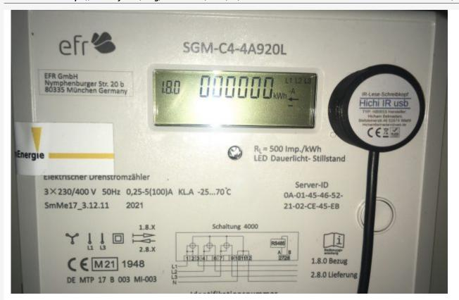
Mit dem Einbau eines neuen bidirektionalen Smartmeters <u>SGM-C4-xxxxxx</u> durch unseren Stromversorger funktioniert das leider nicht mehr. Problem ist nicht etwa, daß die Kommunikation nun mit 9600/8/N/1 läuft, das Problem ist daß die binäre SML Zeichen, die nun jede Sekunde kommen, nicht richtig interpretiert werden.
