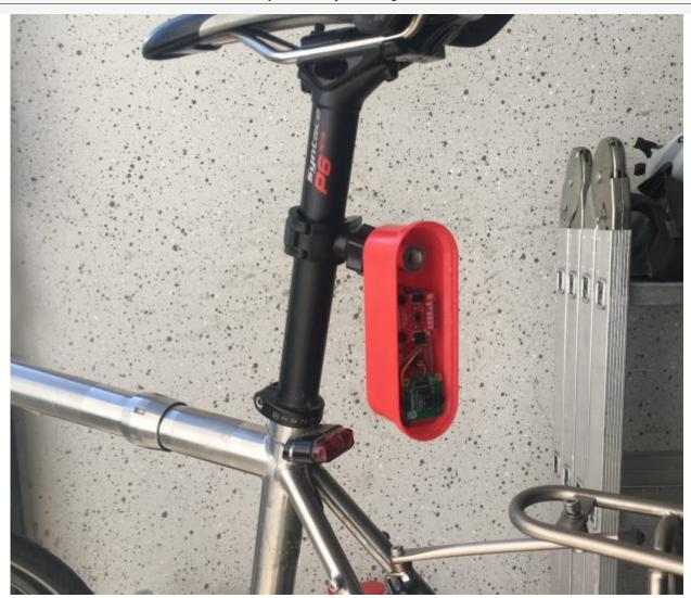
Erste Versuche zeigen, dass der Sensor millimetergenau misst (field of view liegt bei 25 Grad). Die Kamera braucht aber zu lange zum starten, damit ist das überholende Fahrzeug schon längst vorbei. Also zu nächst habe ich nun auf <u>permanenten Videostream</u> mit 50 fps umgestellt, von dem die Videodaten nur dann gesichert werden, wenn ein Objekt unter 1500 mm Abstand erkannt wird.
