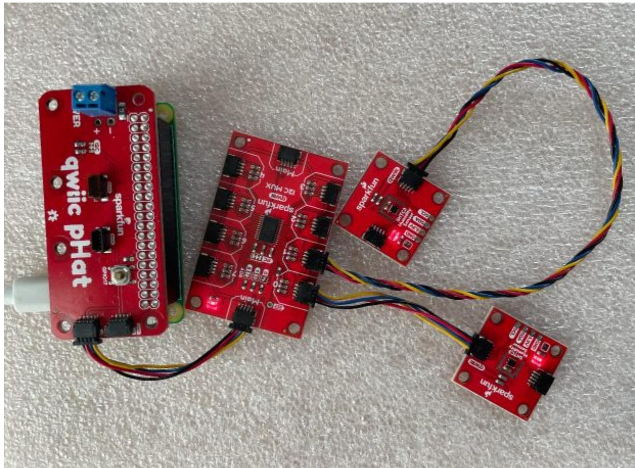
Da die physikalische I2C Adresse des SHTC3 nicht geändert werden kann, brauchen wir zusätzlich ein [Mux Board](#), das mit einer Lötbrücke auf dem ADR0 Jumper die Adresse von 0x70 auf 0x71 ändert.
